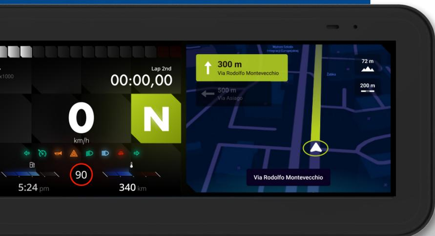
Pensato principalmente per permettere ampia visione e possibilità di aumentare le informazioni sul cruscotto, il **display CANVIEW 8 wide** permette di inserire funzionalità aggiuntive, garantendo un'ampia visibilità grazie alla alta risoluzione del suo display (1280x480).
