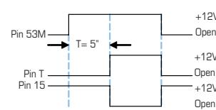
Il pin 53M è l'ingresso di attivazione positivo. Il pin T è l'uscita positiva NO, il pin 15 è l'uscita positiva NC. L'attivazione dell'ingresso pin 53M sul fronte di salita, attiva l'uscita pin T e disattiva l'uscita complementare pin 15 dopo un ritardo di 5 s. La disattivazione dell'ingresso pin 53M disattiva immediatamente l'uscita pin 53S e attiva l'uscita complementare pin 15.
