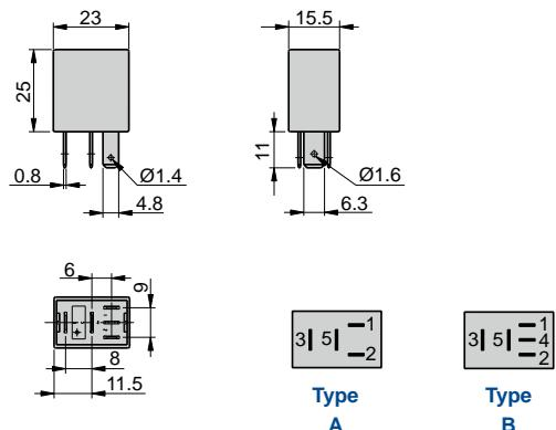
Schema Elettrico - Wiring diagram
