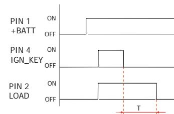
Il pin 4 (IGN\_KEY) è l'ingresso di attivazione positivo. Il pin 2 (LOAD) è l'uscita positiva.
